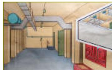
**Убежище** – инженерное сооружение, в котором в течение определенного времени обеспечиваются условия жизнеобитания людей с целью защиты от современных средств поражения, поражающих факторов и воздействия химических и радиоактивных веществ.
